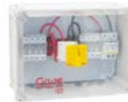
EQUIPOS DE CONEXIÓN FOTOVOLTAICA: Equipos de desconexión de 4-6 strings con protección fusible y/o sobretensión.
